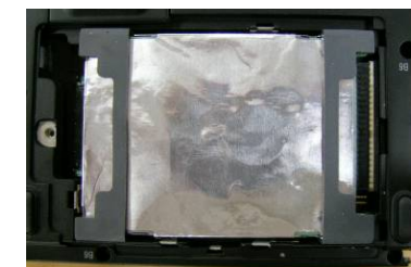
Die Festplatte wird mit stoßdämpfendem Material umgeben und fungiert als Eckstoßfänger.
